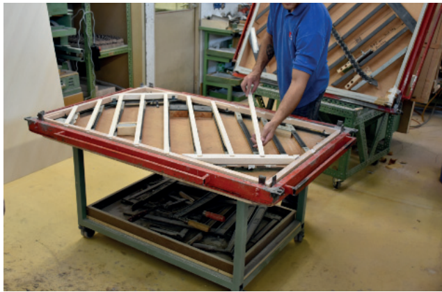
Der Fertigungsprozess für die Verbindung Bodenlager, Rippen und Resonanzboden zur „Sphärischen Wölbung“: In einer Form werden die Rippen mit Leim versehen aufgebracht.
